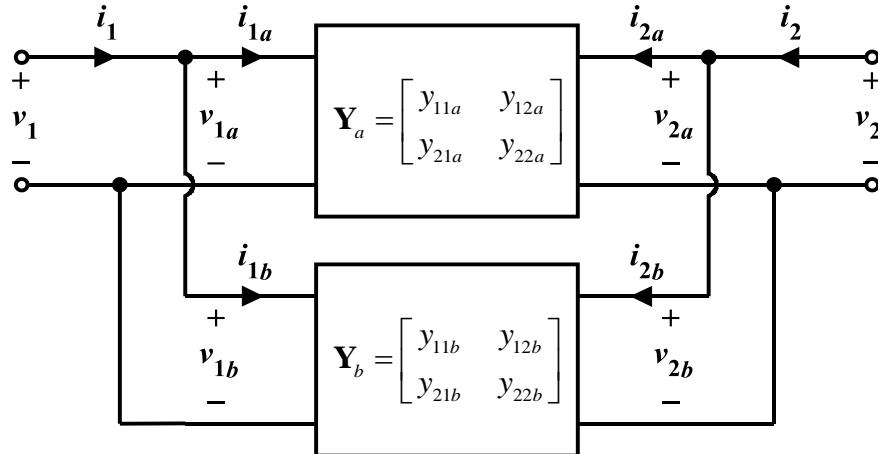
$$v_1 = v_{1a} = v_b$$
