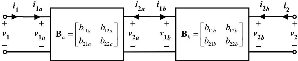
$$\begin{bmatrix} v_2 \\ i_2 \end{bmatrix} = \begin{bmatrix} v_{2b} \\ i_{2b} \end{bmatrix}$$
