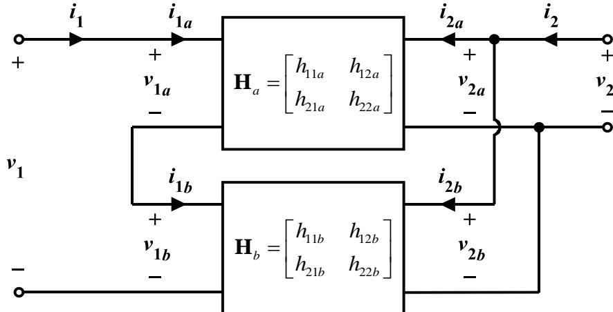
$$v_1 = v_{1a} + v_{1b}$$
