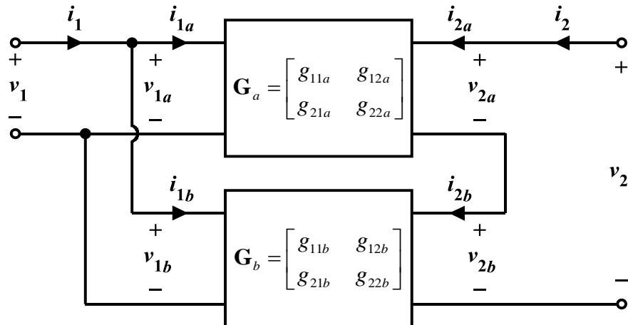
$$v_1 = v_{1a} = v_{1b}$$
