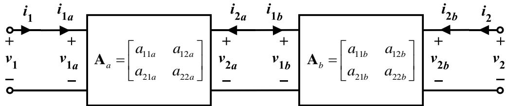
$$\begin{bmatrix} v_1 \\ i_1 \end{bmatrix} = \begin{bmatrix} v_{1a} \\ i_{1a} \end{bmatrix}$$
