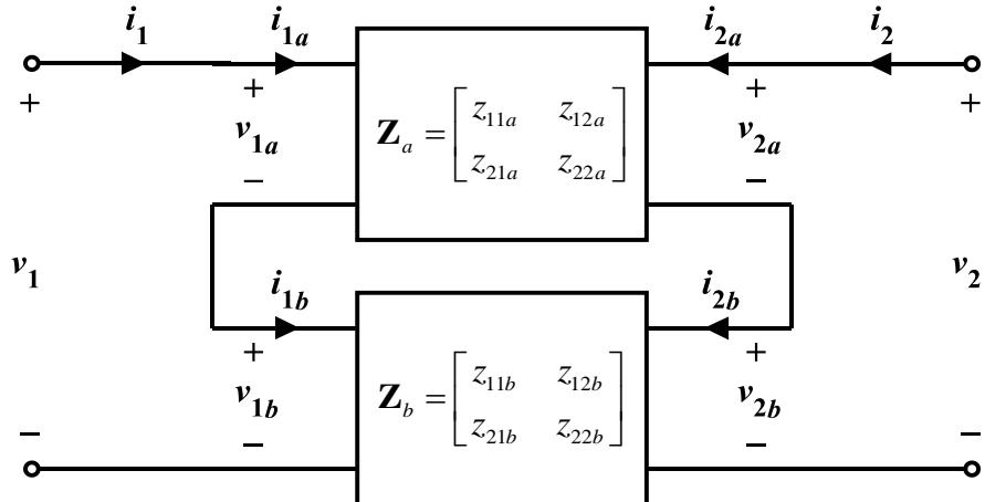
$$v_1 = v_{1a} + v_{1b}$$
